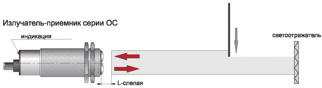
Рисунок 10. Оптический бесконтактный выключатель серии ОС - излучатель-приемник в одном
